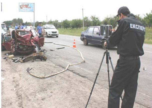
Рис. 3. Лазерне сканування ділянки дороги експертом-автомехніком під час огляду місця ДТП
