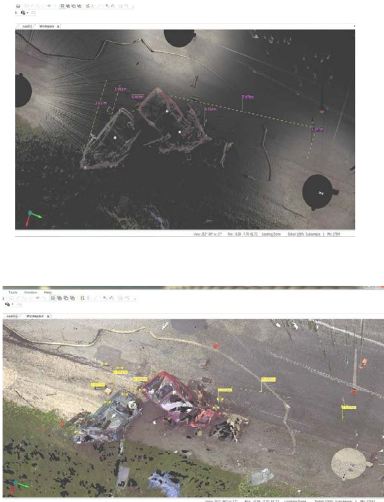
Рис. 6. Скановане зображення, що покладено у основу схеми ДТП з відповідним 3D-зображенням
