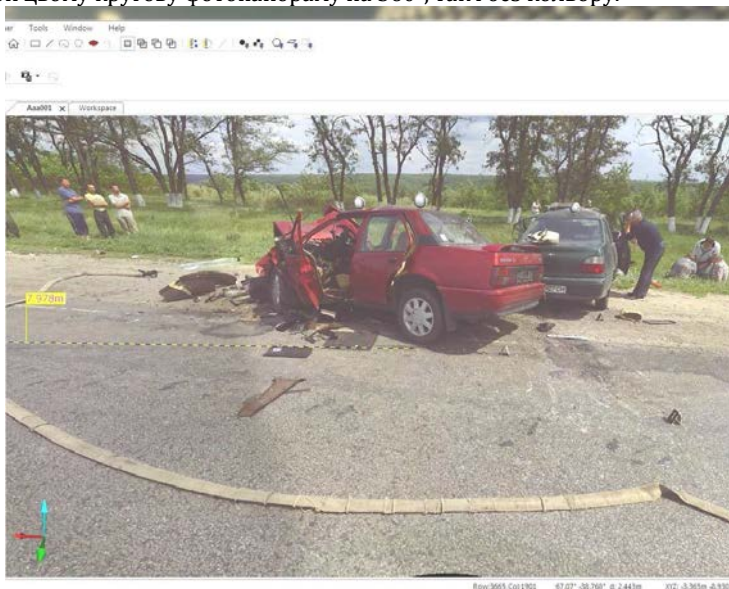
Рис. 4. Отриманні зображення при лазерному скануванні місця ДТП
