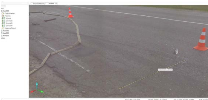
Рис. 7. Сканований слід гальмування автомобіля після збільшення
